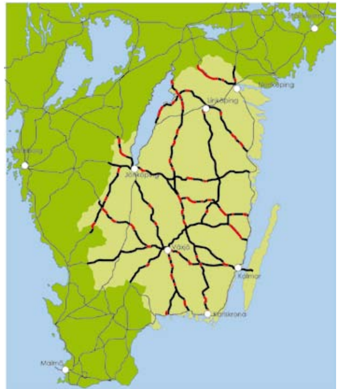
Riksvägar i östra Götaland. På röda avsnitt är hastigheten 70 km/tim eller lägre. Det behövs stora åtgärder för att uppnå ett säkert och snabbt vägnät. Målet är mötesfri väg med minst 90km/tim.
